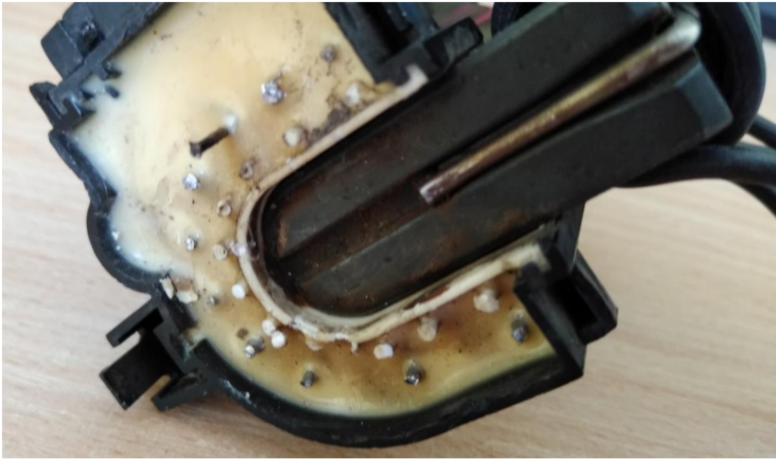
Rys. 3. Skrócone nóżki transformatora HV
