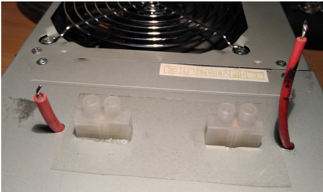
Rys. 19. Przyklejone złączki elektryczne wraz z podkładką izolującą
