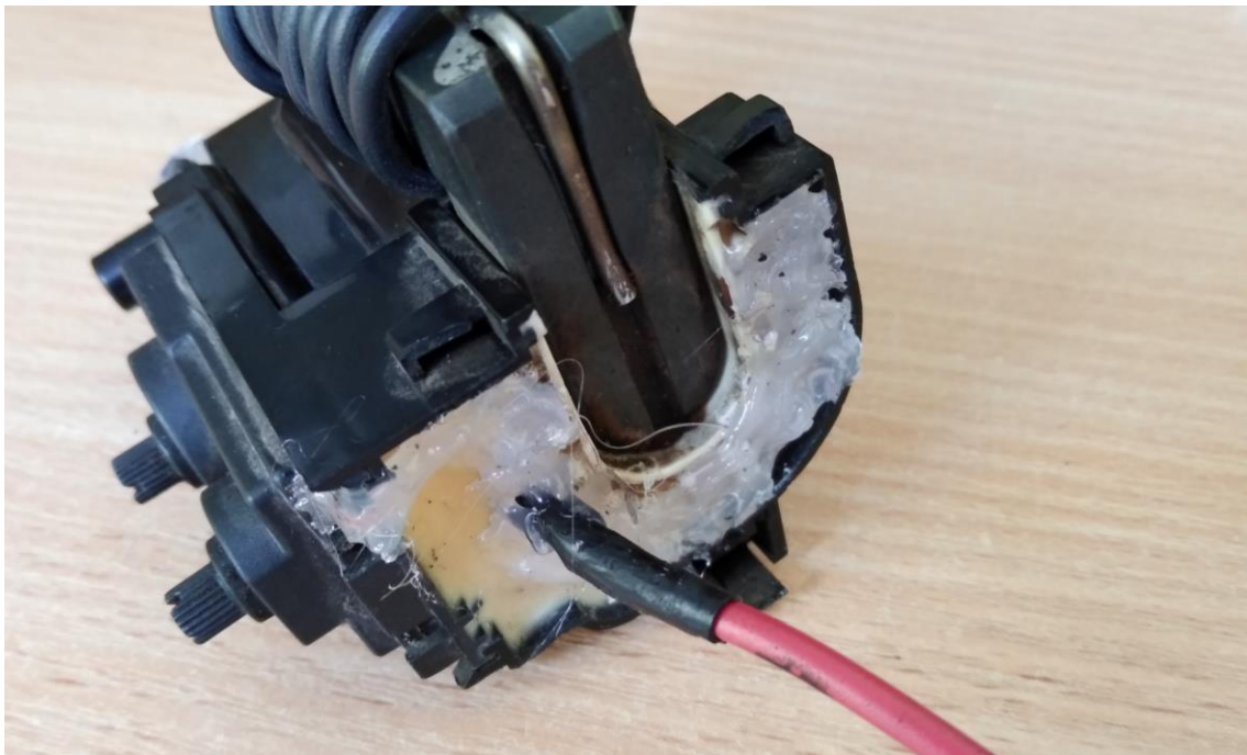
Rys. 4. Zaklejone wyprowadzenia transformatora HV
