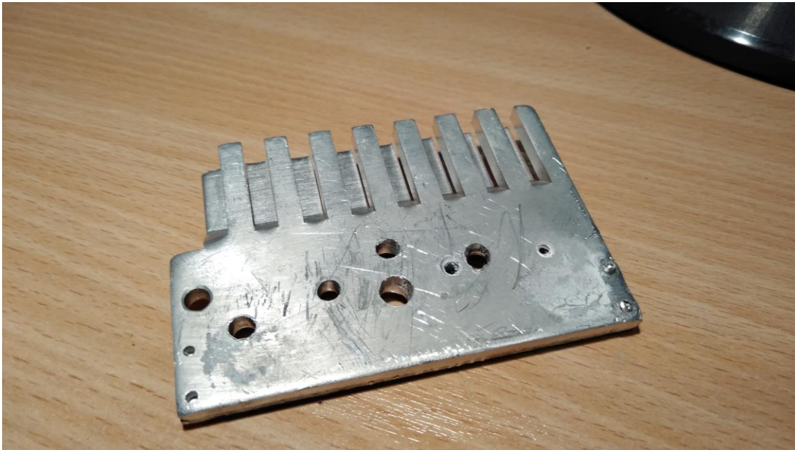
Rys. 11 Gotowe otwory montażowe pod tranzystor w radiatorze
