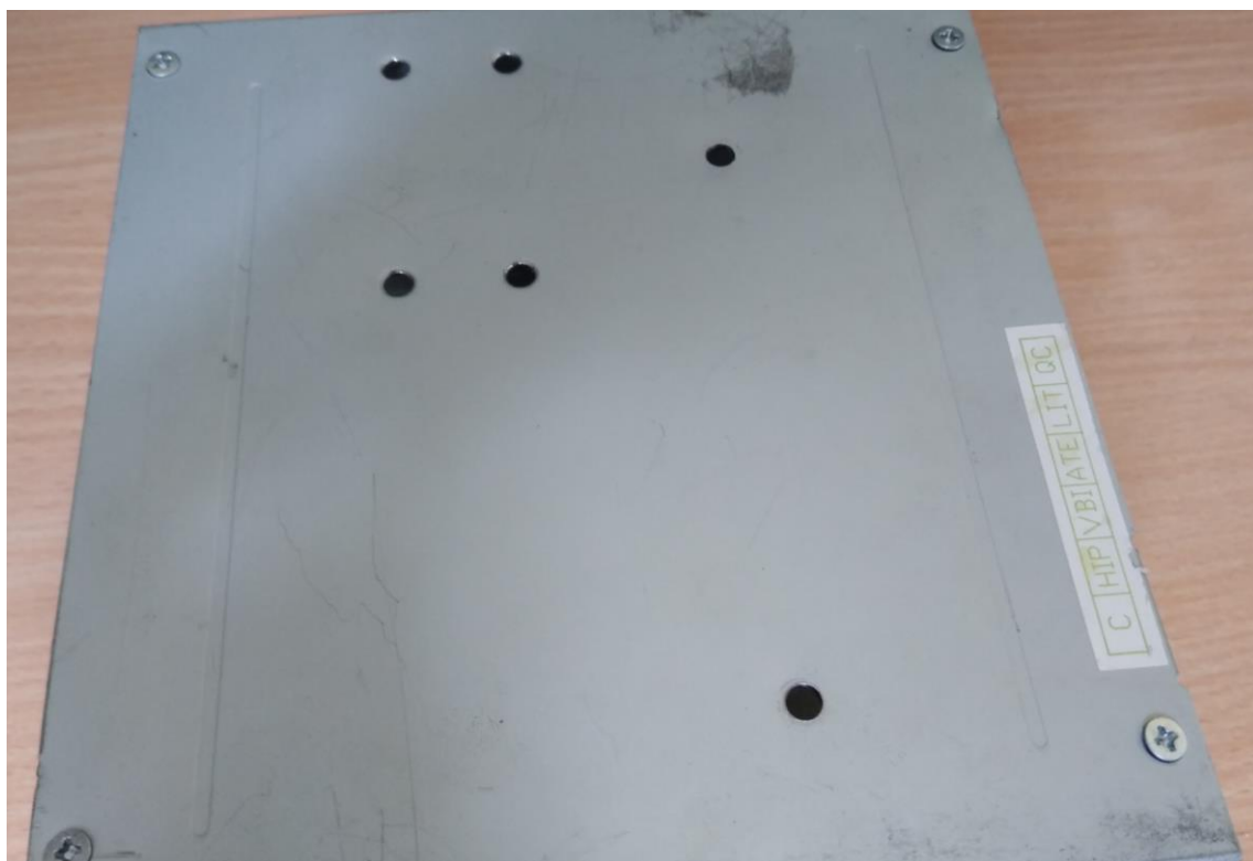
Rys. 9. Gotowe otwory do przeprowadzenia przewodów wysokiego napięcia
