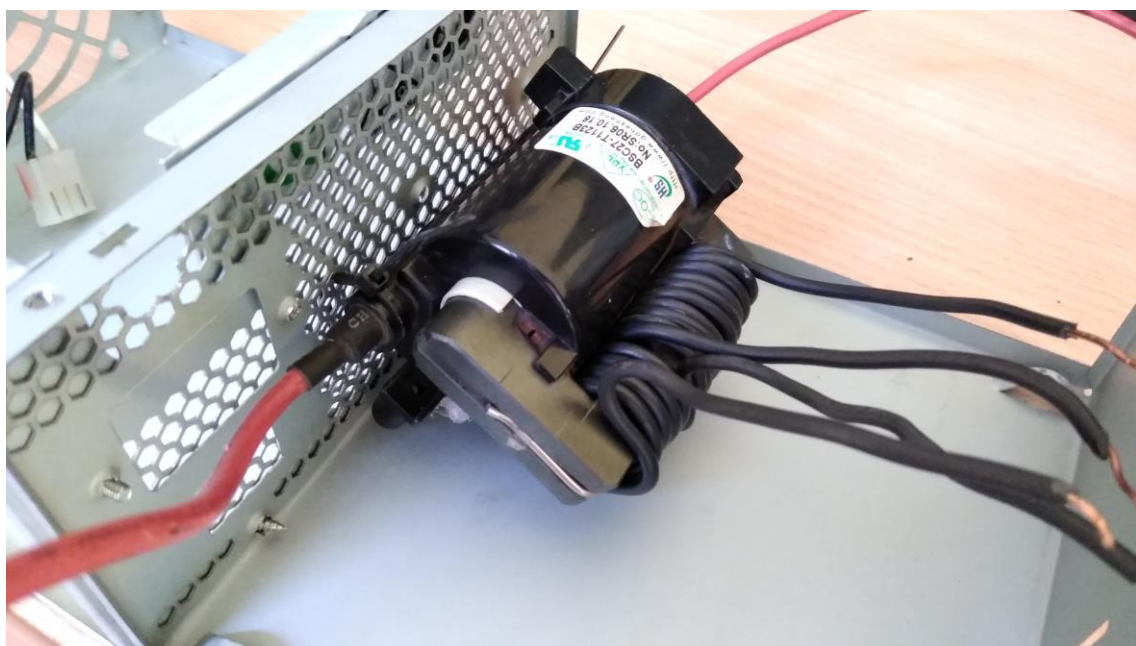
Rys. 10. Zamontowany transformator HV w obudowie
