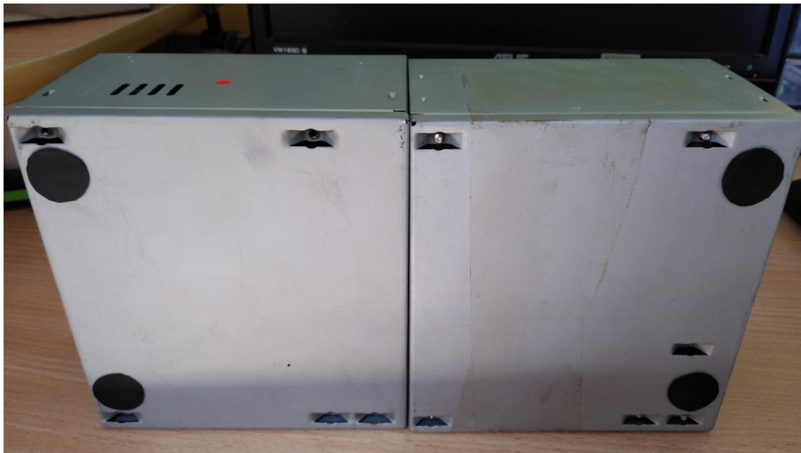
Rys. 21. Przyklejone podkładki gumowe
