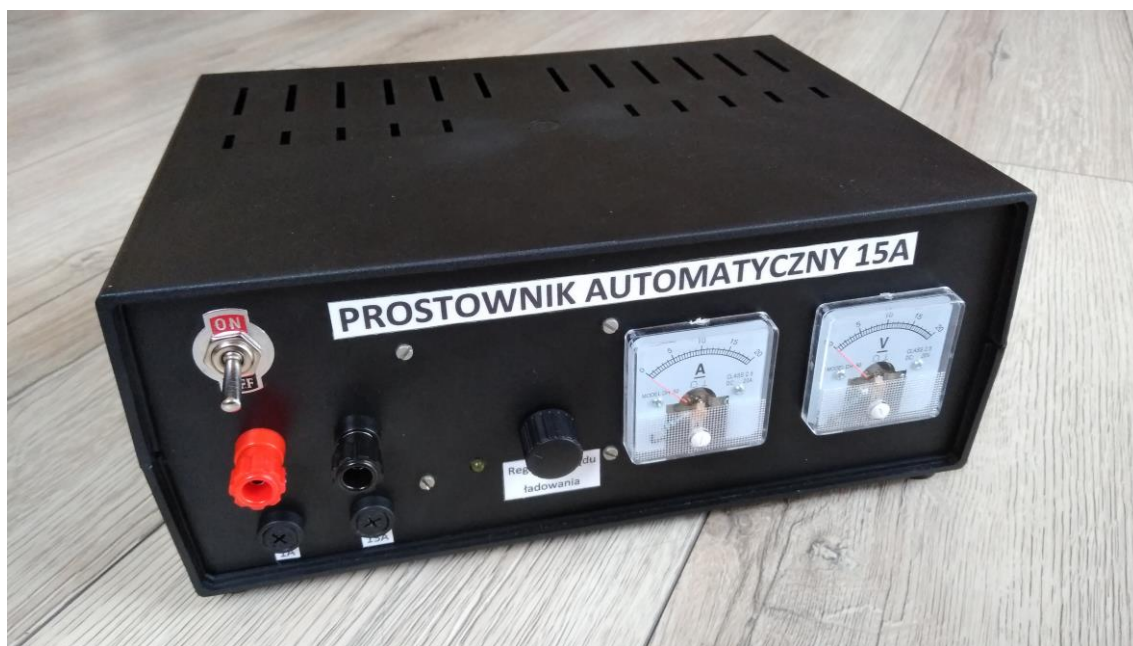
Rys. 26. Prezentacja skończonego prostownika automatycznego 15A
