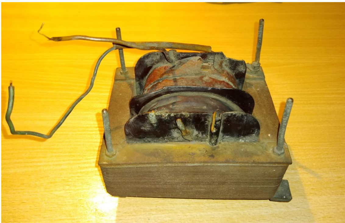
Rys. 11. Zdjęcie pogładowe przedstawiające transformator
