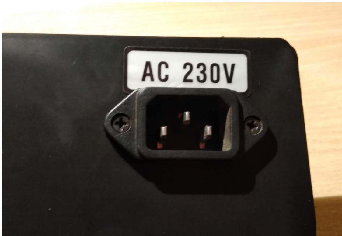
Rys. 15. Tylny panel obudowy po montażu gniazda zasilającego Gniazdo oraz naklejka zostały pozyskane z uszkodzonego zasilacza komputerowego ATX.
