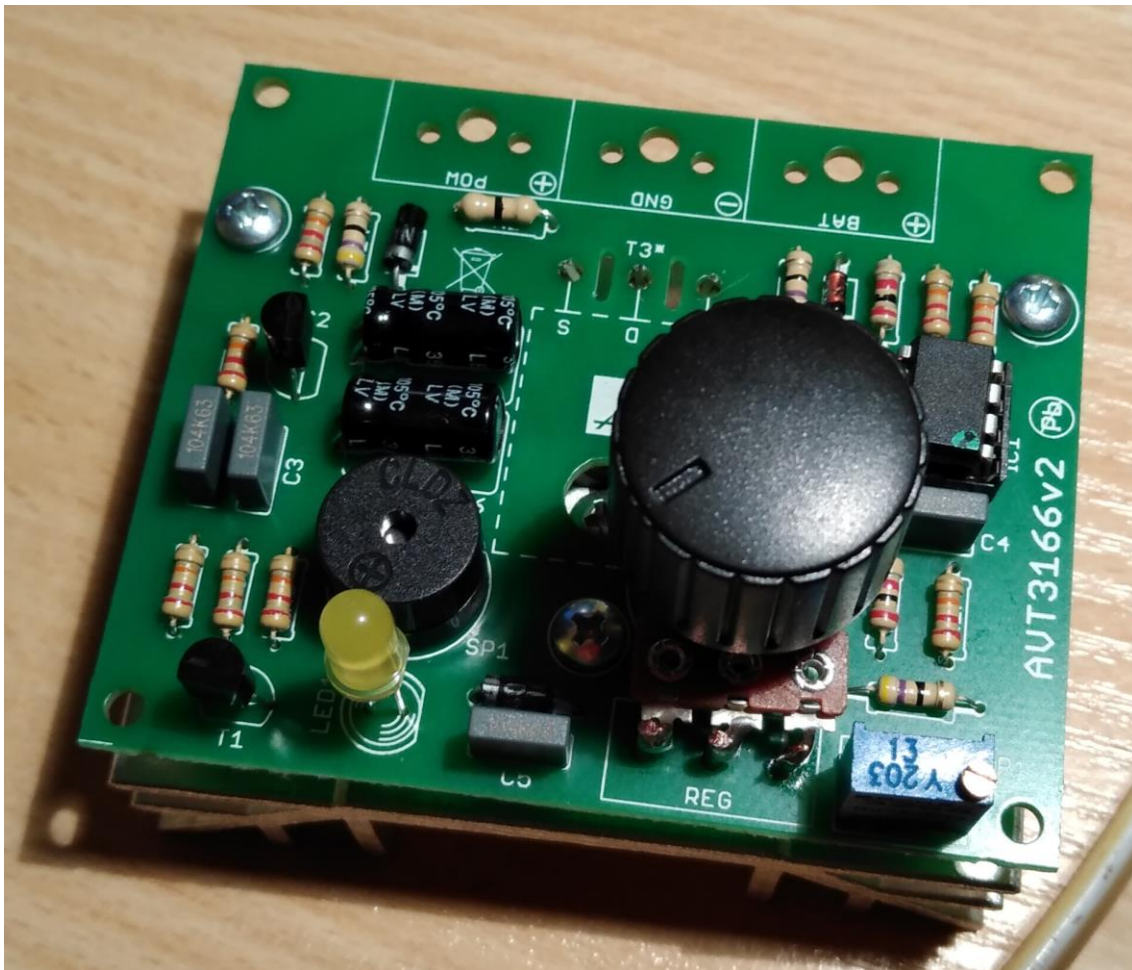
Rys. 9. Gotowy regulator do prostownika
