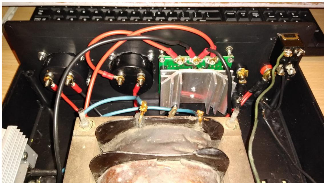
Rys. 23. Zdjęcie przedstawia w pełni połączony przedni panel prostownika
