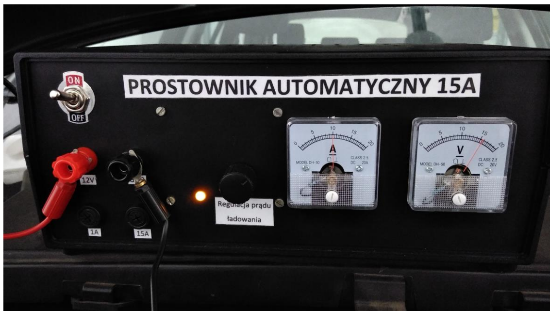
Rys. 27. Prostownik podczas ładowania akumulatora w samochodzie
