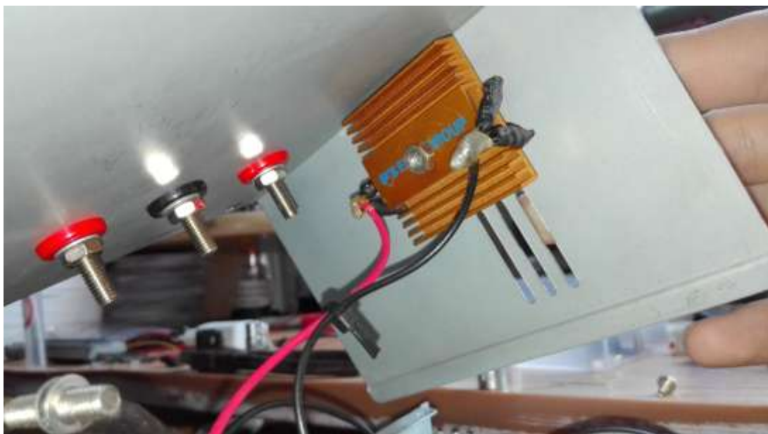
Rys. 13. Widok mocowania rezystorów oraz wyjść napięciowych.
