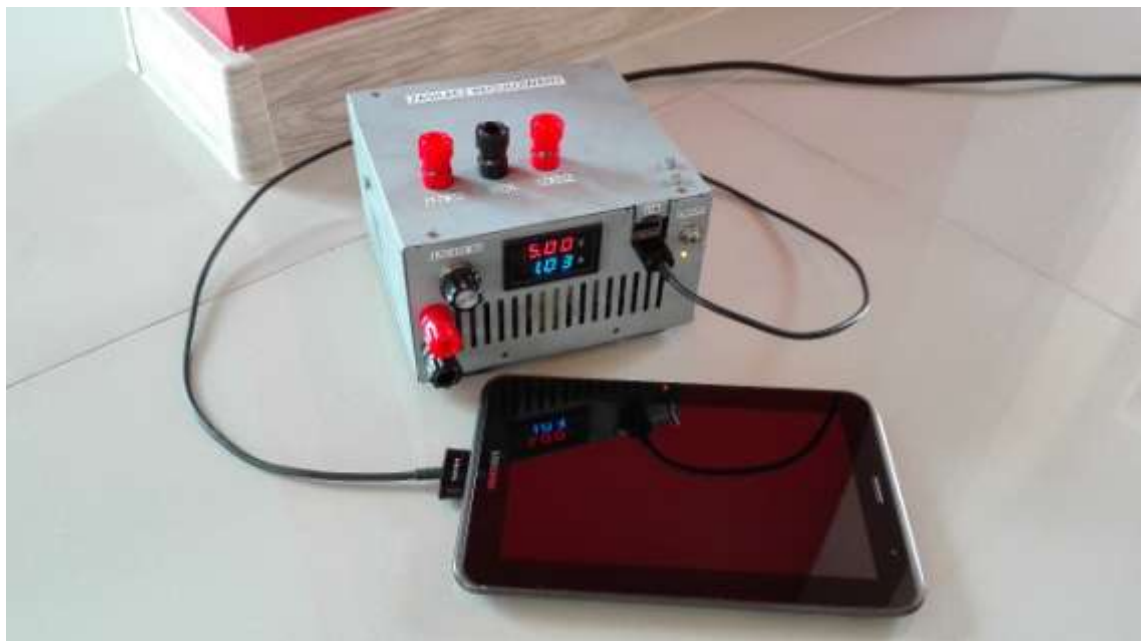
Rys. 16. Prezentacja działania zasilacza.
