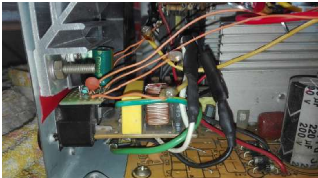
Rys. 10. Zdjęcie poglądowe przedstawiające wejście zasilacza oraz układ LM 350.
