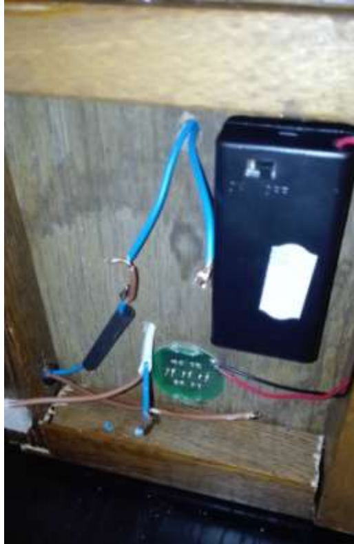
Rys. 17. Łączenie przewodów pod podstawką.
