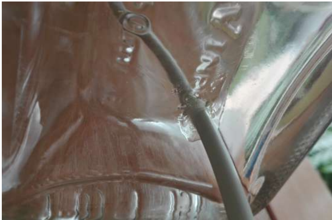
Rys. 13. Widok od spodu butelki przedstawiający schnięcie kleju.
