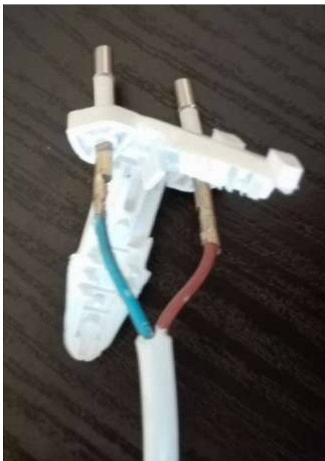
Rys. 19. Gotowa wtyczka już do złożenia.
