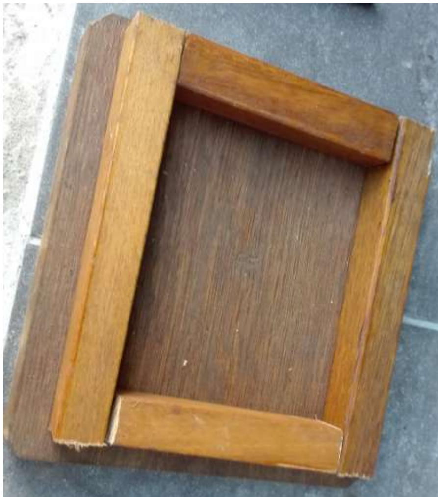
Rys. 5. Spasowanie szkieletu podstawki pod sklejenie.
