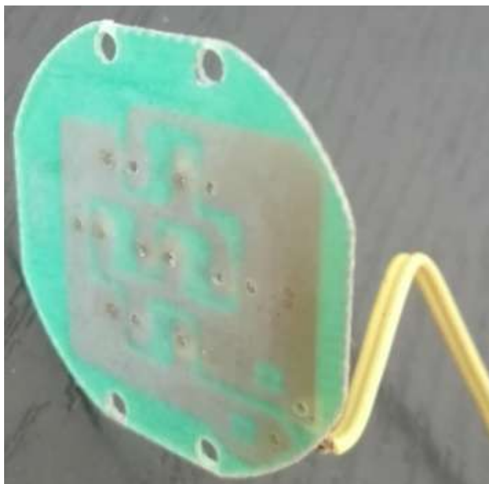
Rys. 7. Płytkę pod diody RGB po wylutowaniu zwykłych.
